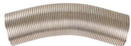
**FUMINOX** – Flexibler Schlauch mit Rippen hergestellt aus dickerem, hochkolagenem, nichtrostbarem Stahlband (Inox, nichtrostbarer Stahl AiSi 304 nach ASTM 167 nach JUS C 458) verbunden mit zweischichtigen Flächten.
